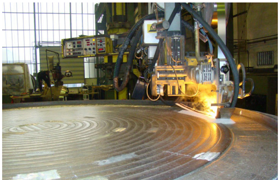
Bild 2 Aufschweißen (Plattieren) einer korrosionsbeständigen Stahlschicht
